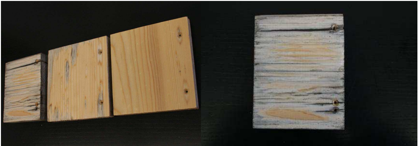
Überblick Holzschutzversuch Spanien 2011-2013 Nur 1-K Holzschutzlack
